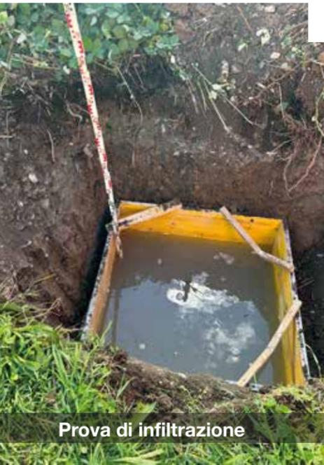
Prova di infiltrazione
